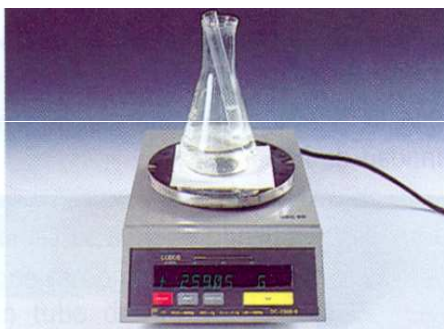
Se introduce el tubo en el matraz y se pesa el conjunto.
